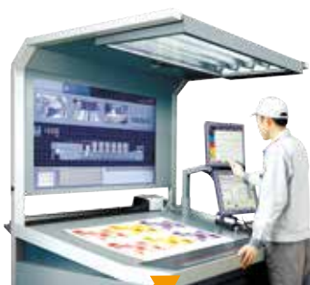
「プレスインフォメーションディスプレイ」を搭載したオペレーションスタンド
