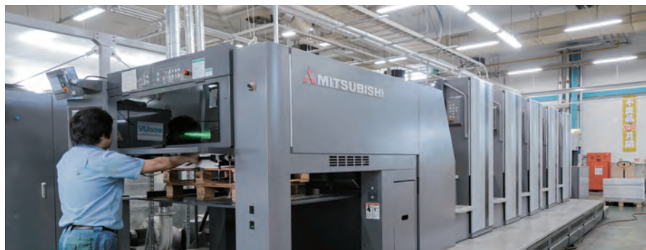
ecoUV搭載 菊全判オフセット印刷機 DIAMOND V3000LS-5
