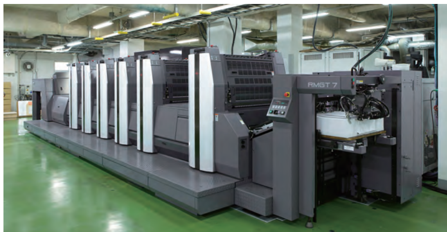
LED-UV乾燥装置搭載 B2判両面兼用6色オフセット印刷機 RMGT 790PF-6
