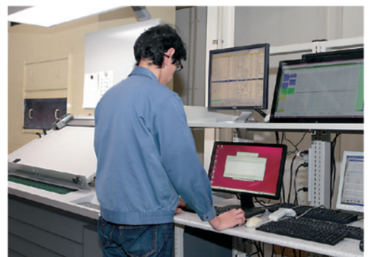
MISから転送されたジョブデータで印刷機の自動プリセットを実施
