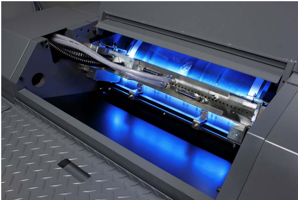
LEDを採用したUV乾燥装置
