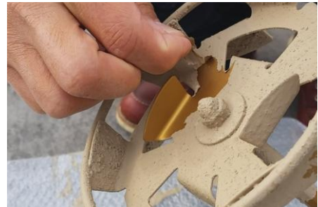
洗浄せず塗料がスクリー部に固着した状態
