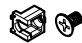
⑱ ⑲ コールコード受け一式 (露出配線の場合のみ使用します)
