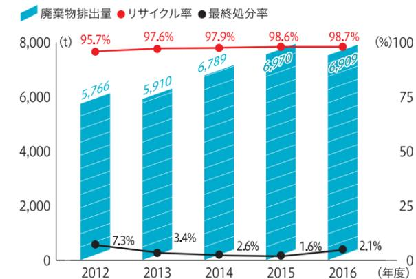
$$\text{リサイクル率} = \frac{\text{C再資源化量}}{\text{A廃棄物排出量} + \text{B有価物量}}$$
