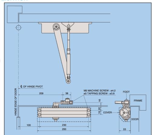
**■ CLOSER MOUNTED ON PULL SIDE OF DOOR**
