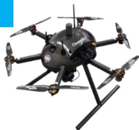
再現性の高い飛行撮影が可能で高精度位置情報を持つドローンを利用して構築した仮想空間に時間情報を付加することで、インフラ設備の長寿命化に向けた施設の経年劣化が把握できます。
