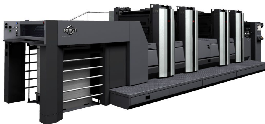
A 全判 4 色片面・両面兼用印刷機 RMGT 920V1PF-4
