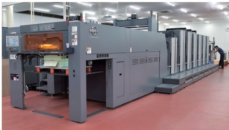
菊全判6色機 RMGT 1020ST-6 (LED-UV、コーティングユニット搭載)
