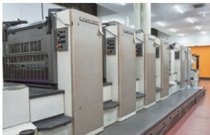
2004年に導入した三菱重工製菊全判6色機 NEWダイヤ306W
