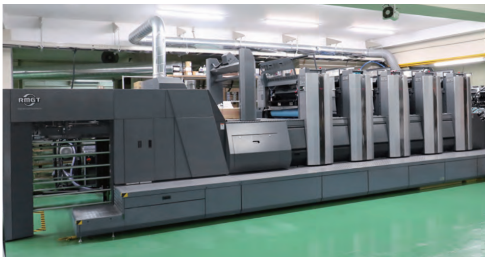
LED-UV、ニスコーティングユニット、品質検査装置搭載の RMGT 920 モデル
