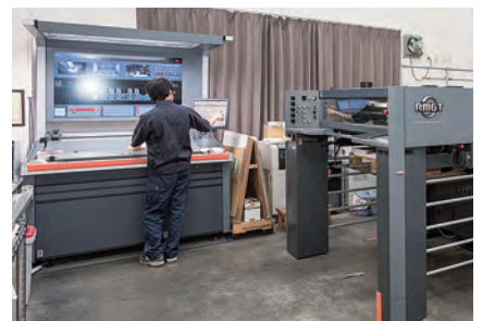
55インチ大画面モニターで印刷機各部を確認しながら操作できる、プレスインフォメーションディスプレイ
