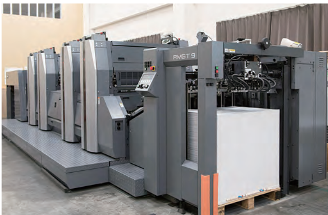
両面即乾印刷に効果を発揮するA全機 RMGT 920PF-4+LED-UV
