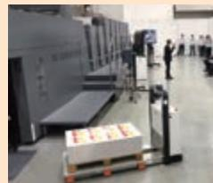
「自動搬送ロボット(AGV)」による用紙搬送
