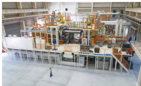
型締力6,500トンの超大型ダイカストマシン
