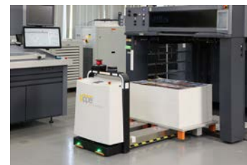
（左図）印刷用紙の供給・印刷物の搬送をAGV※と連動
